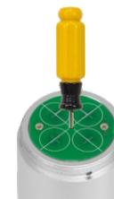
6-4 拔出螺丝刀，盖上并拧紧电池盖。调节完成。
