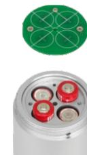
4-4 并盖上电池板，用螺丝刀把2个固定螺丝旋紧。
