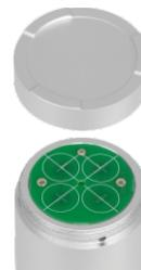
4-2 用螺丝刀旋开2个固定螺丝，拿起电池板。
